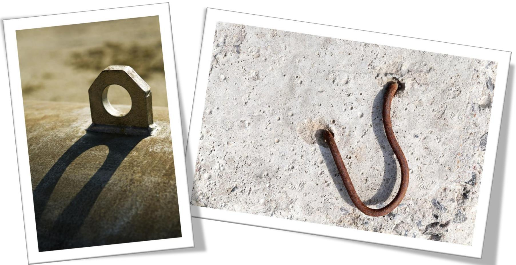
Cualquier punto dispuesto en la "carga" de manera inseparable, para facilitar su izado, es parte de la carga y no parte del accesorio
