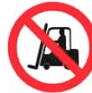
Prohibido a los vehículos de manutención
